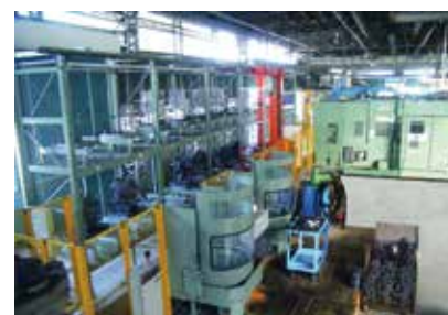
ポンプケーシング加工ライン
